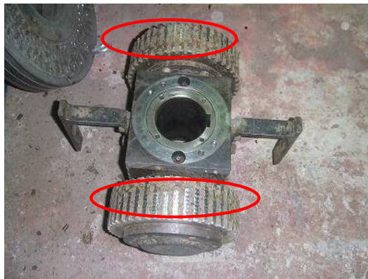
写真 5-12 ローラ面の膜
