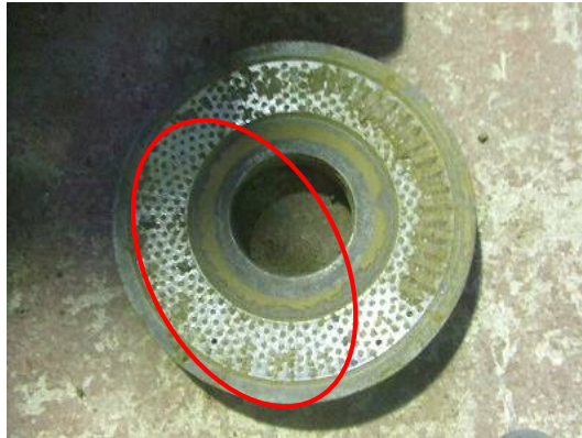
写真 5-11 ダイス面の膜
